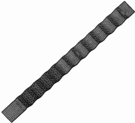
图 3 纵向对称加力室 A 隔热屏网格图
